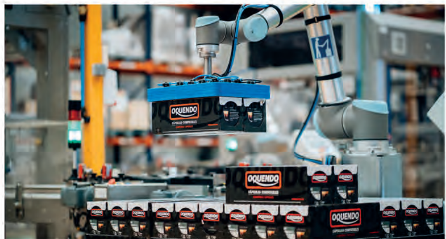
Paletizadora en la fábrica de Cafés Oquendo
